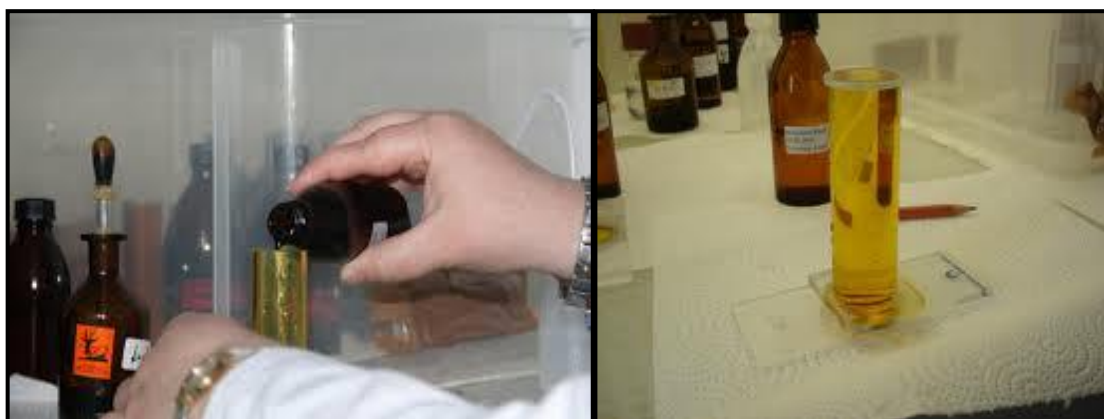
Figura 5.1 Utilización de cámaras de sedimentación para la preparación de las muestras de fitoplancton según el método de Utermöhl.
